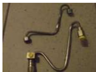
Doppelwandige Einspritzleitungen nach Muster
